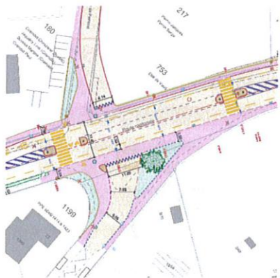
Figure 10 – Extrait du plan des aménagements: aménagement de la traversée de la voie verte sur le secteur du carrefour du Banc-des-Pauvres à Saint-Prex
